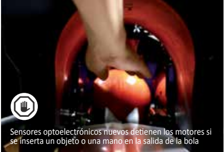
La nueva máquina de retorno de bola Harmony está asegurada con llave y se puede remover con un mínimo esfuerzo
